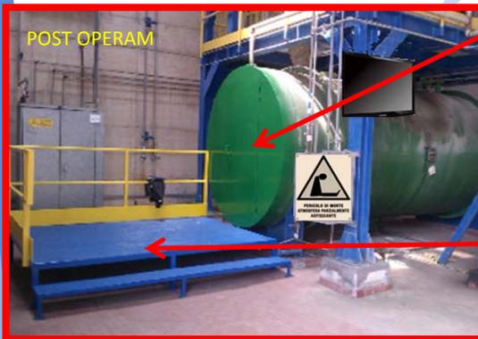
La pedana agevola l'uscita dal serbatoio in caso di emergenza ed un monitor, collegato ad una videocamera installata al suo interno, monitora le fasi di recupero durante la fase di l'addestramento
