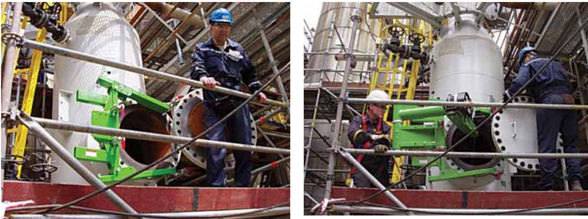
Fig. 8. Ancoraggio mobile per il recupero persone a “braccio entrante”. Pensato per serbatoi e reattori . Produttore dbi-sala-ucl safety systems http://en.capitalsafety.us
