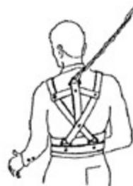
Fig. 22 - Cintura di sicurezza «anticaduta»
