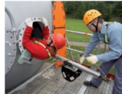
Abbildung 26: Seitenmontage mittels spezieller Kälterung des Rettungshubgerätes
