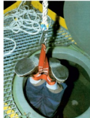
Abbildung 28: Rettungsschleife (besonders geeignet zum schnellen Retten)
