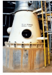
Abbildung 8: Schuss unter einer Kolonne
